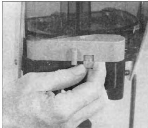
3. Извлеките два винта из фирменной планки. Снимите загрузочную рейку и установите требуемые мерки для дробин и пороха, согласно таблице по зарядке. При сборке, винты закручивайте аккуратно, не перетягивая их.
