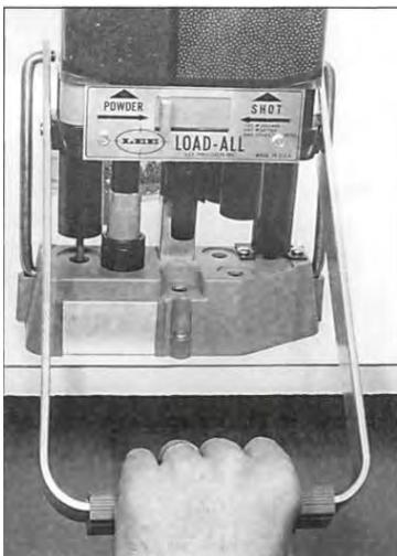
**ГНЕЗДО 2.** Поместите капсюль в капсюльное отверстие ГНЕЗДА 2. Поместите гильзу в ГНЕЗДО 2; потяните за ручку вниз. Калибровочное кольцо сбрасывается автоматически. Снимите его с гильзы.
