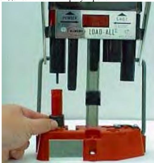
**ГНЕЗДО 1.** Наденьте на гильзу калибровочное кольцо так, чтобы конец с канавкой был вверх. Установите гильзу в ГНЕЗДО 1 и потяните за ручку вниз. Произойдет полная обжимка по длине и извлечение использованного капсюля из гильзы.
