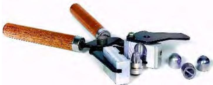
**ПУЛИ. (Slugs)** Компания Lee выпускает пулелейки, позволяющие отливать пули, которые легко заряжаются с помощью Вашего Lee Load All-2. Кроме того, точность таких патронов лучше, чем фабричных, несмотря на то, что используются стандартные пыжи – обтюраторы и гильзы.
