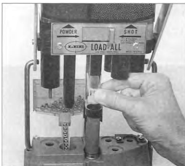
**ГНЕЗДО 3б.** Поднимите ручку, вставьте соответствующий пыж и опустите ручку до упора.
