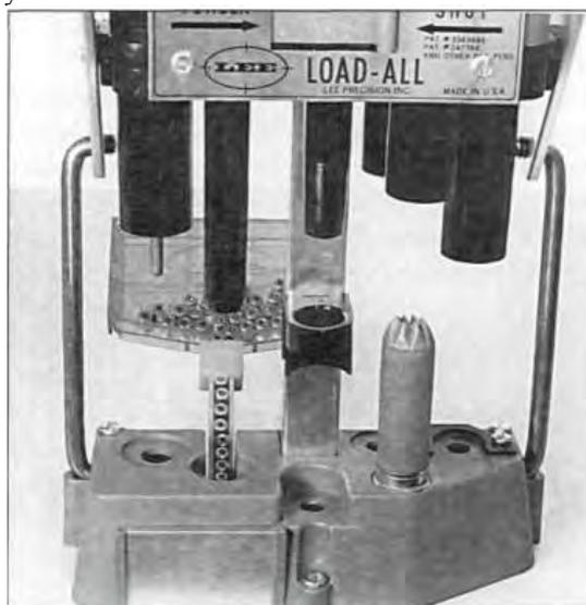
**ГНЕЗДО 4.** Поместите гильзу под соответствующий бур - надрезатель. Придерживайте внутри бура гофрированное дульце гильзы для правильного совмещения надрезков гильзы с ребрами бура. Нажмите ручку до упора. Для некоторых гильз может понадобиться две секунды для усадки пластика.
